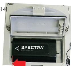
5. Fermer la trappe batterie: Une bonne pratique consiste à utiliser ces deux pouces pour exercer une pression sur les deux coins de la trappe. Cette méthode permet de bien refermer le verrou et de préserver l'étanchéité du compartiment batterie.
