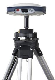
**Base locale** Le SP85 peut être utilisé en base locale, fournissant ses corrections au travers d'un des dispositifs suivants :
