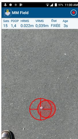
Vous devez alors orienter l'appareil de telle sorte que les deux réticules deviennent concentriques et de couleur verte, ce qui signifie alors que l'appareil est bien de niveau. Puis déplacer doucement l'appareil sur un plan horizontal de telle sorte que les deux réticules se positionnent exactement au-dessus du point au sol que vous souhaitez enregistrer :
