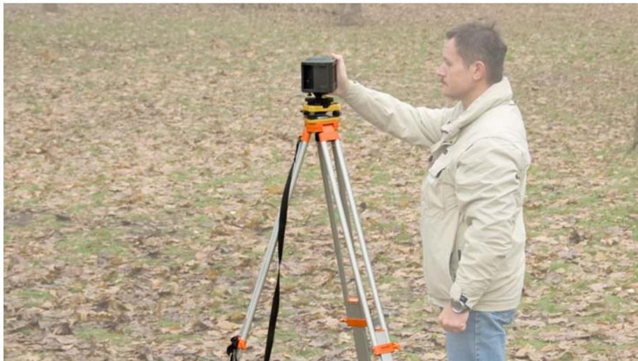
**Figure 14. TRIUMPH-VS on tripod**
