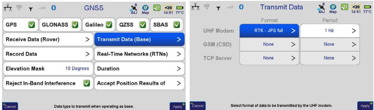
**Figure 35. Transmit data parameters**
