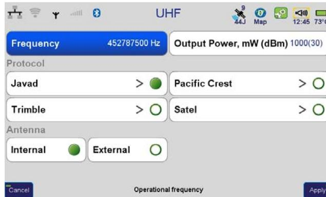
**Figure 80. UHF parameters**
